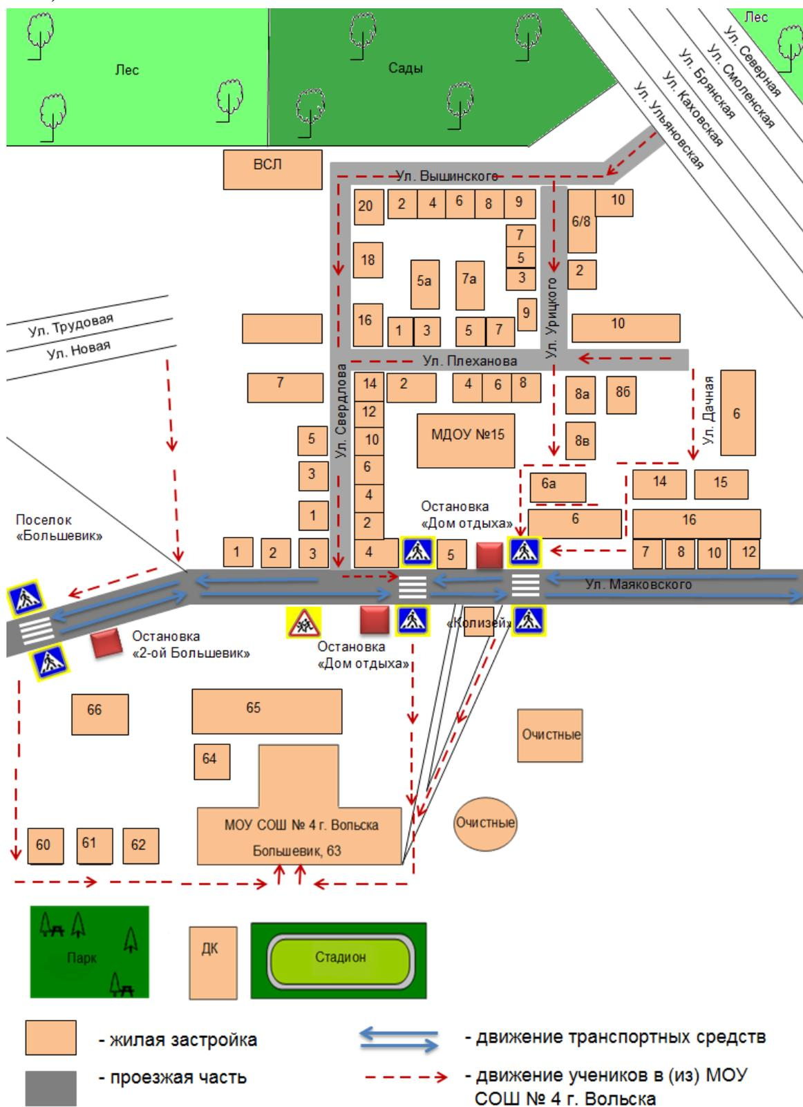
2. **СХЕМА** организации дорожного движения в непосредственной близости от МОУ ВМР СОШ № 4 г. Вольска с размещением соответствующих технических средств, маршруты движения детей и расположение парковочных мест (СХЕМА № 2)
